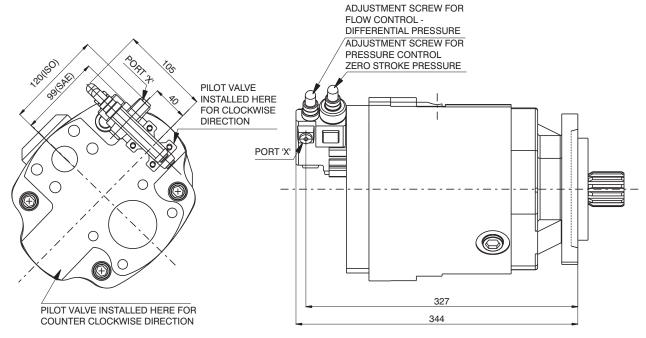
**PORT 'X' DETAILS:-**ISO : M14x1.5 ; 12 DEPTH SAE : 7/16 -20 UNF - 2B ; 10 DEPTH
